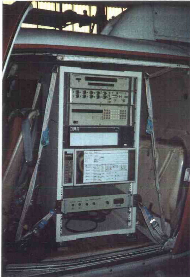
Figur 1: Einbau des Messsystems in einem Ecureuil-Helikopter
