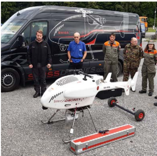
Abbildung 11: Messmittel (1L NaI-Szintillator) des LS mit für diese Übung zur Verfügung gestellter Drohne (Swissdrones)
