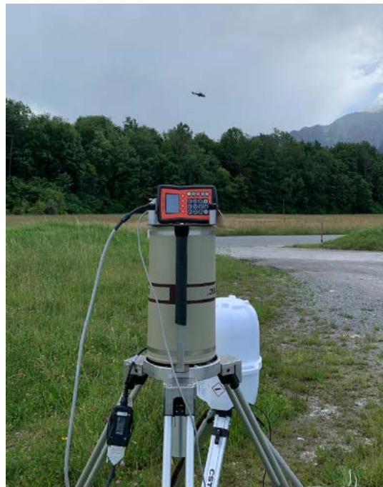
Abbildung 13: In-Situ Gamma Spektrometrie (grau) und Referenzmessgerät (weiss)
