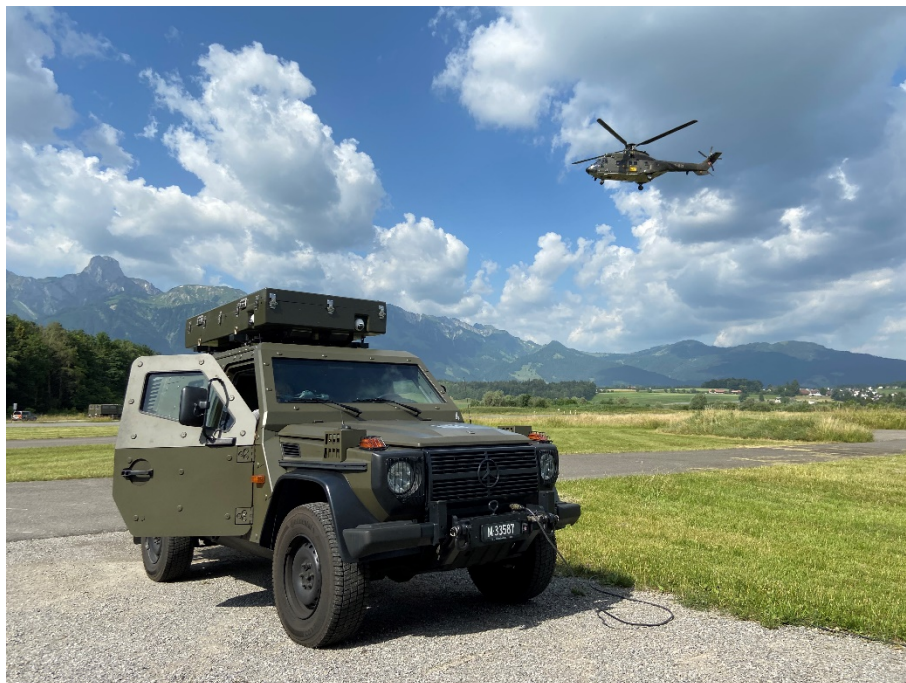
Boden- und Aeroradiometriesysteme gleichzeitig im Einsatz.
