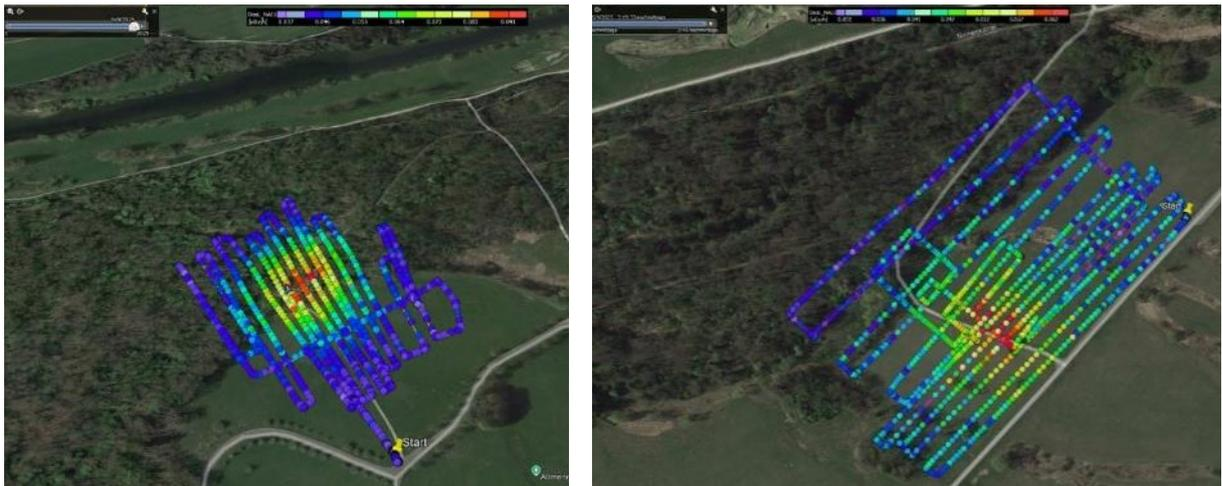
Abbildung 23: Mission 4 – Quellensuche mit Drohnen: ODL-Karten der beiden für die Drohnen definierten Messgebiete, erstellt vom Team CHE des Labors Spiez.
