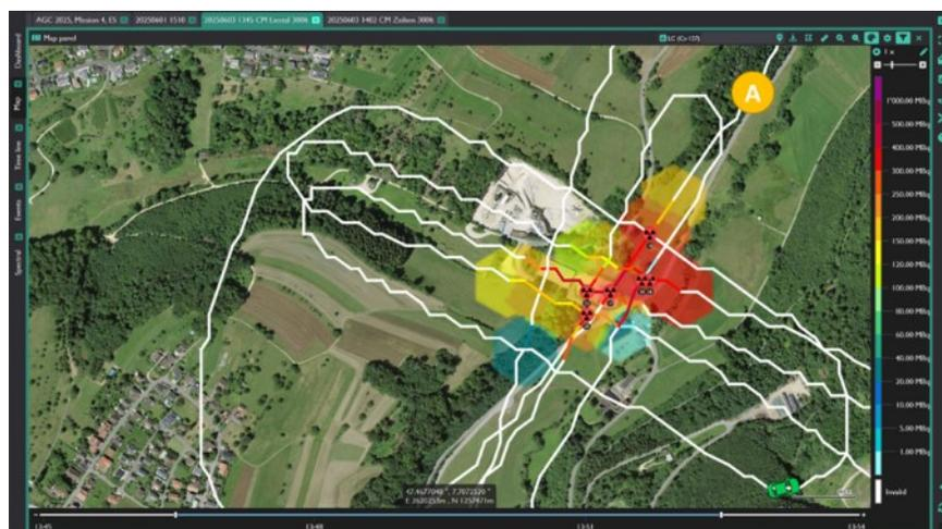
Abbildung 13: Mission 3 – Quellenidentifikation südwestlich von Liestal: Screenshot der Messsoftware, nach mehrmaligem Überflug des Quellenstandortes.
